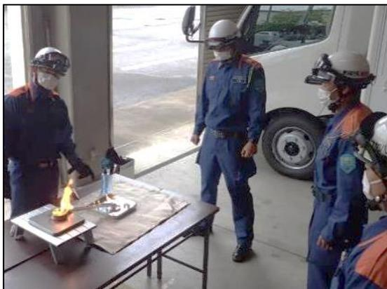
【ガソリン蒸気引火実験の様子】
